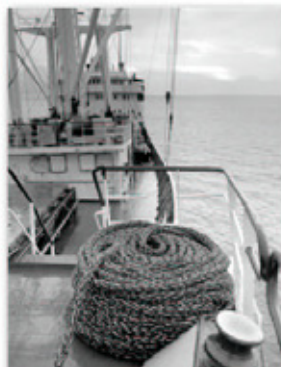
Polypropylenové pletené lano na přídi loď Radhošť 1985.
