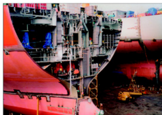
Nahoře: Strojovna před přídílní zadní sekce s komínem listem a šroubem.
